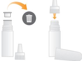
**HR:** Odvijte čep i nastavak na tubi s ljepljivom. Noktima skinite prozirni čep koji zatvara tubo. Ponovno pričvrstite nastavak. Ljepilo je spremno za upotrebu.
